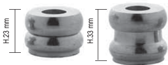
Ferro zincato / Iron H.23 - 33 mm Art. 13.510 Ø 30 - foro10,5 H.23 - 33 mm Art. 13.511 Ø 35 - foro14,5
